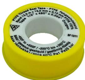
Gewindedichtband aus ungesintertem PTFE. Chemische Beständigkeit gegen aggressivste Medien. Versprödet, quillt und klebt nicht. Enthält kein Öl und Fett. Verhindert das Festrostern (Leichtes Lösen nach Jahren selbst bei Stahlschrauben in Aluminium). Für Metall und Kunststoffgewinde geeignet.
